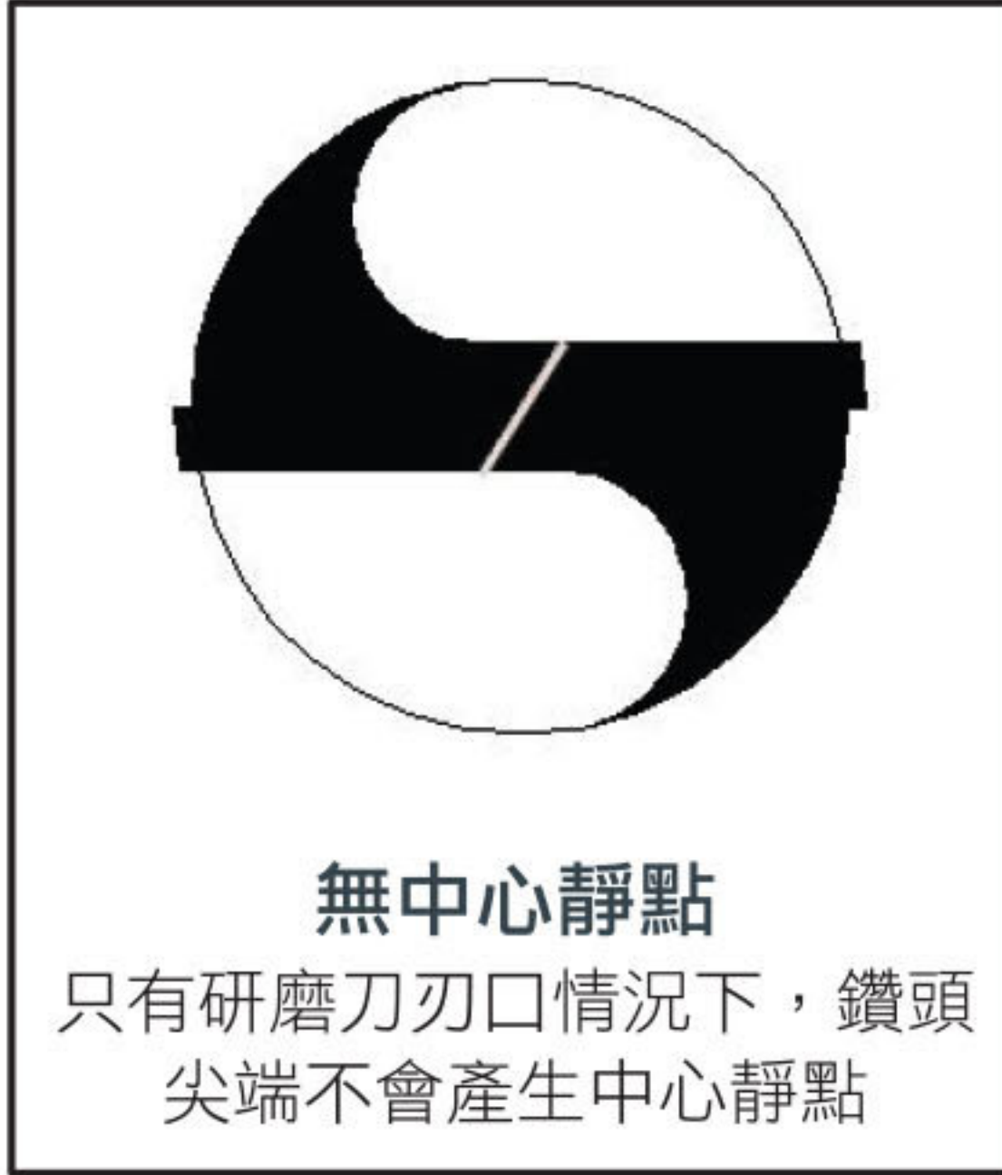
標準中心靜點厚度 無加墊片研磨下，中心靜點厚度為0.2mm-0.4mm
