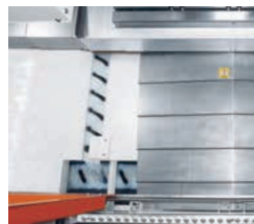
底板沖屑(Vc-F106) + 螺旋式排屑
