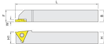
功能: 開槽 Grooving / 螺紋 Threading
