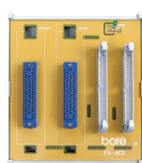
FA-XH50M-2-G 提供 48IN / 32OUT 端子對接 2組FANUC A03B 控制器中繼模組應用
