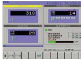
提供使用者加工件計數功能，具有超循環警報功能，易於控管加工循環時間
