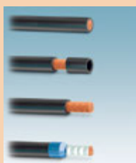
處理電線前端 (壓接套接管)
