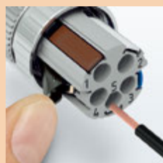
打開解除桿·插入電線後再關閉解除桿
