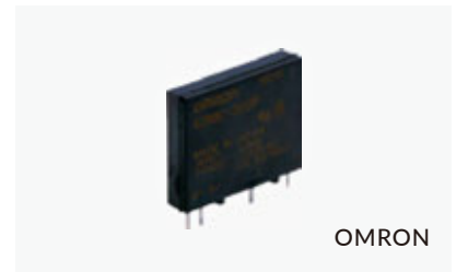
G3MC 固態繼電器 1a / 2A G3MC-202P-DC24
