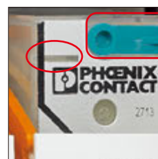
接點側標示與測試拉桿
