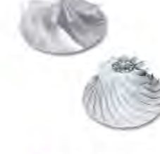
▲ 五軸同動的工件範例
