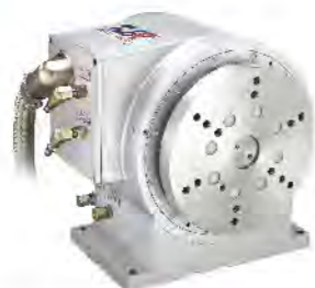
AD-250HS(超高速 2000 rpm) 可當臥車使用
