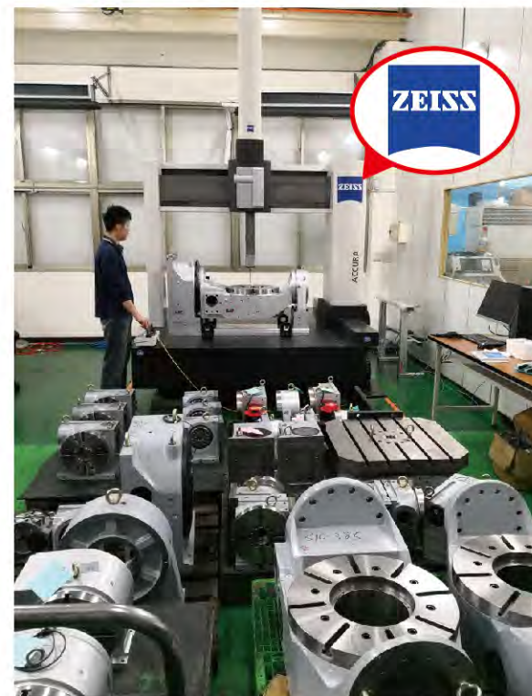
三次元(三座標)檢測儀 檢測幾何精度
