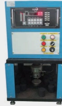
砂模強度試驗機 Foundry Sand Strength Tester 鑄物砂強度檢查裝置
