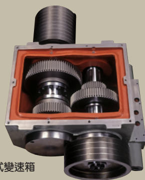
第一段變速 278~834 rpm (速比：5.39)
