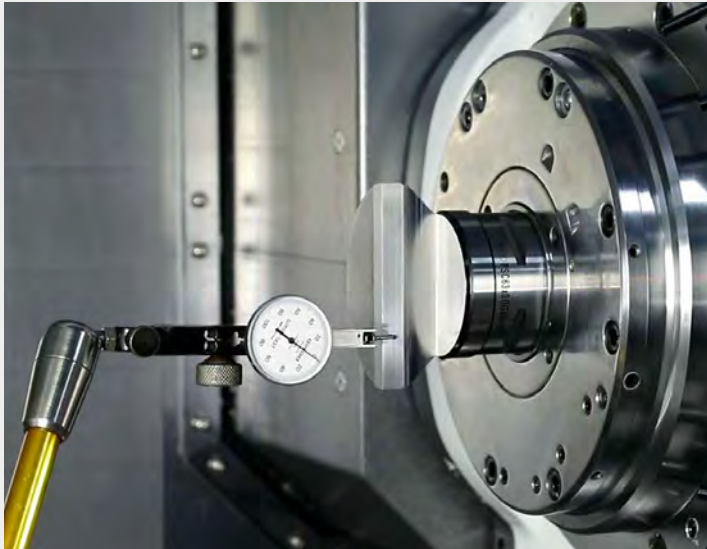
校正車銑複合機主軸精度
