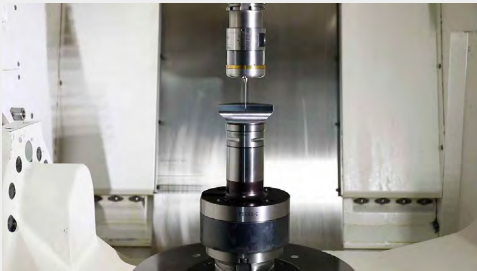
設定五軸加工機轉台C軸加工零點
