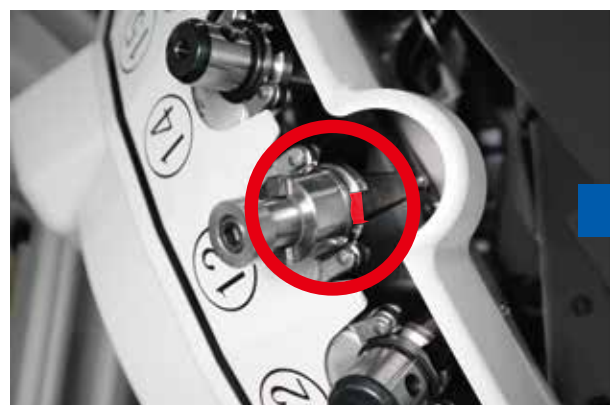
刀具放置角度不正確，傳動鍵未卡入鍵槽
