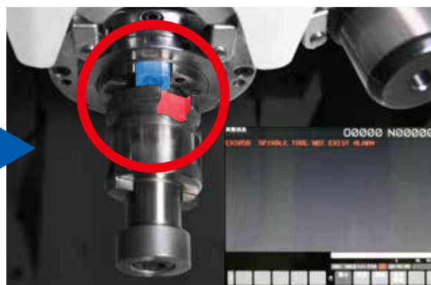
偵測刀具無法完全夾緊，控制器螢幕顯示警報訊息
