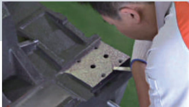
整機接觸面完全超精密級手工刮花
