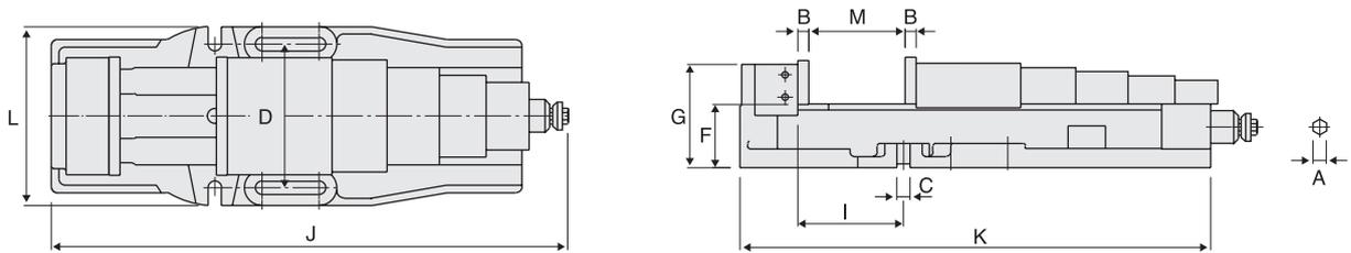
**規格表** (材質: 高精密FCD 60石墨鑄鐵/HRC50°熱處理)
