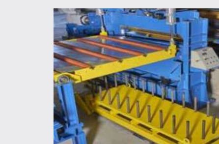
4 料頭剪床/廢料小車 Scrap Shear / Scrap Collector
