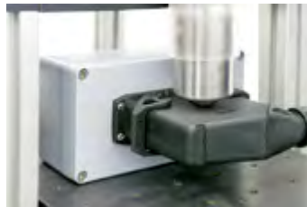
通過嵌合部位耐撞擊性試驗 (符合IK09·IEC62262)
