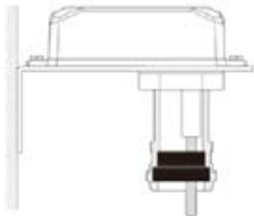
無法在盤面開孔時，可維持保護等級進行安裝的轉接器
