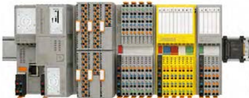
直接連接PLCnext Control與Axioline F 系列I/O模組混合的範例
