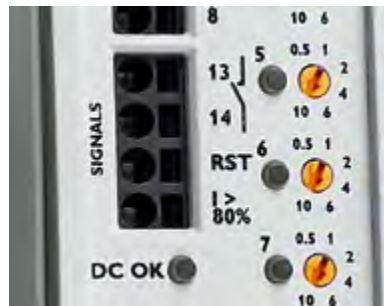
LED顯示、警報接點遠端重設端子
