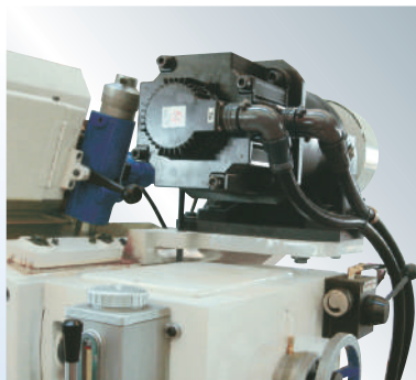
JHC-12S 調整輪以無段變速之伺服馬達驅動。
